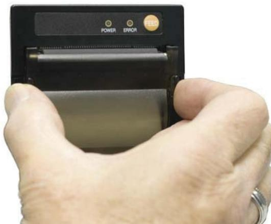
**Figure 3-12** Opening printer door
